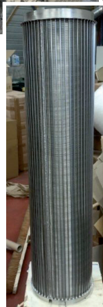
La solution Sofise : le panier filtrant à maille triangulaire
